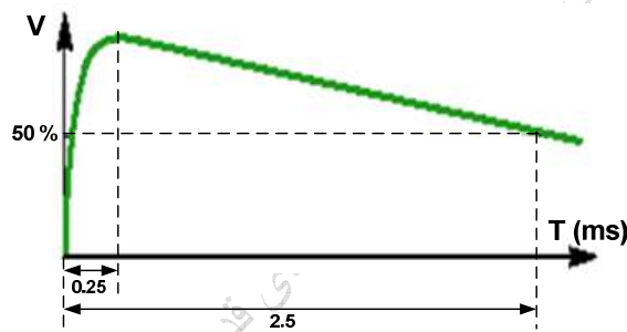
شکل (۲-۶). شکل موج ولتاژ کلیدزنی
