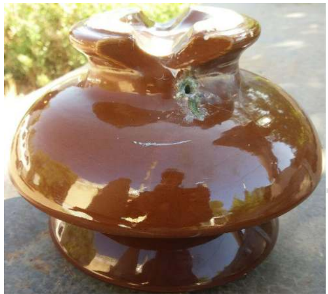
سوراخ شدن مقره در اثر اضافه ولتاژها
