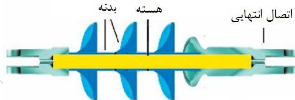
شکل (۵-۳). اجزای اصلی تشکیل دهنده مقره کامپوزیت
