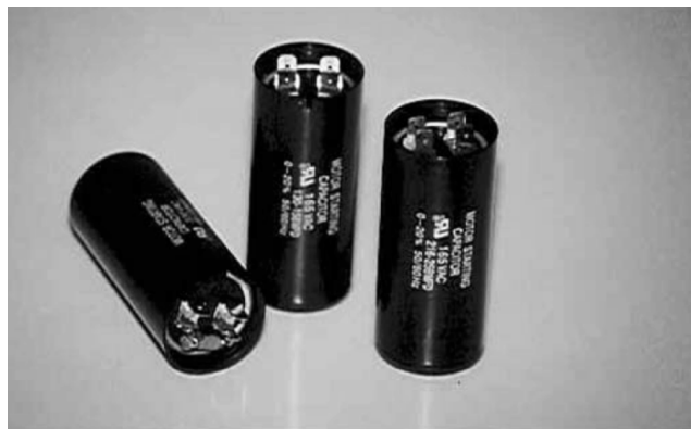
تصویر ۹-۵: خازن‌های الکترولیتی برای راه‌اندازی موتور
